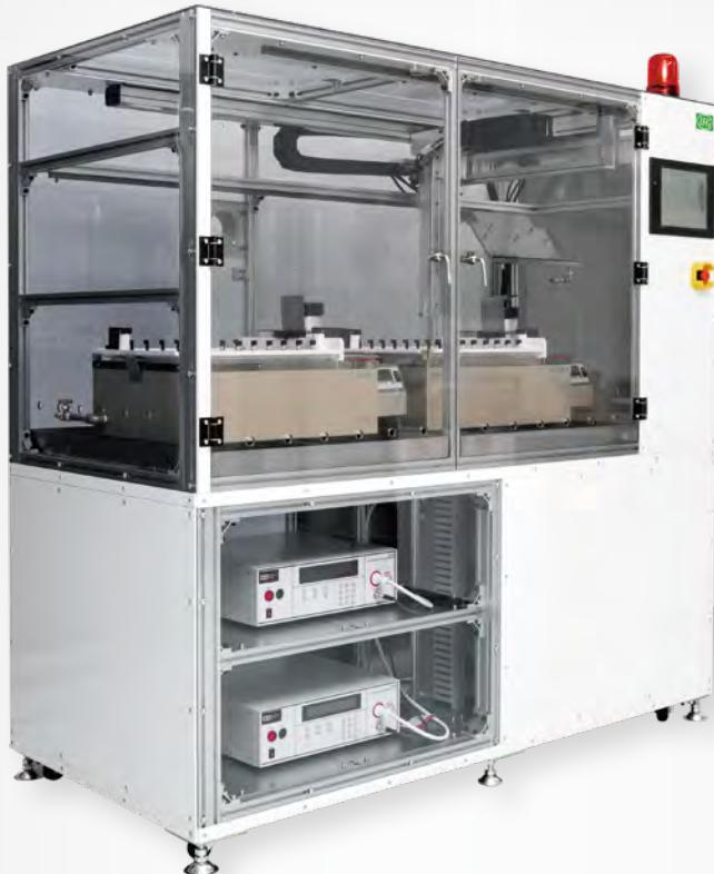
温度制御下にて最大96個のICへの高電圧TDDB試験が可能。試験時間を大幅に短縮。
